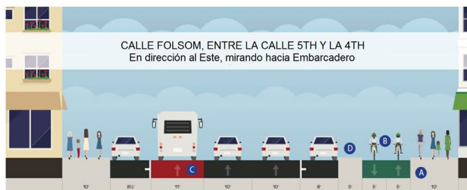
Típica sección transversal del proyecto Folsom Streetscape
