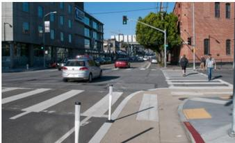
Las **zonas de seguridad pintadas** en Evans Avenue y Napoleon Street mantienen libres las esquinas de las intersecciones y alientan a los conductores a voltear a velocidades más seguras. La **instalación de zonas rojas** en las esquinas de las intersecciones mejora la visibilidad entre conductores y peatones que cruzan la calzada.
